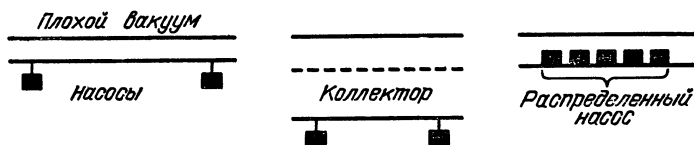
Рис. 50. Две схемы откачки ускорителя, обеспечивающие высокий вакуум: с коллектором и с распределенным насосом
