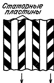
Рис. 59. Вид на пластины турбомолекулярного насоса (разрез вдоль оси насоса). Стрелка — направление движения роторных пластин
