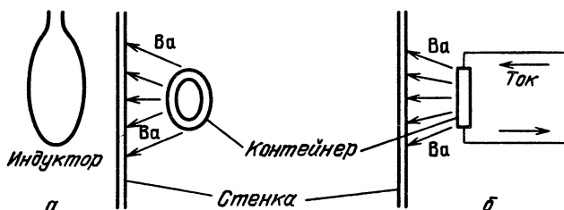
Рис. 24. Способы распыления геттеров: а — нагрев индуктором; б — нагрев током
